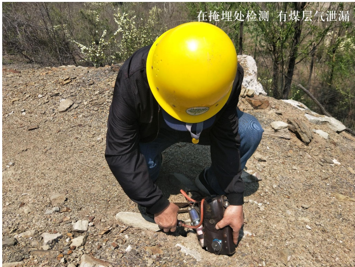
附图 4、南峪区块原煤矿封闭井筒检测有煤层气泄漏图片
